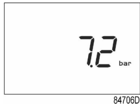
Tela principal com pressão (compressor parado)
