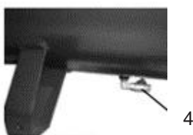
Válvula de dreno de condensados, montados sobre o reservatório
