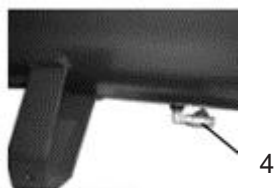
Válvula de dreno de condensados, montados sobre o reservatório
